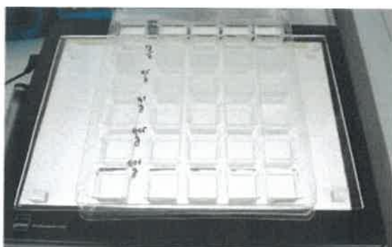
Echipamente microbiotest pentru testarea toxicitatii cu crustacee
