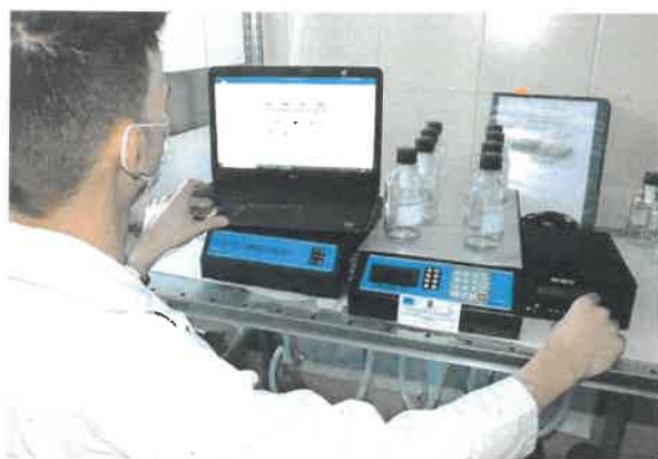
Instalație pentru teste respirometrice (rata de respirație a namolului activ în prezența toxicului)
