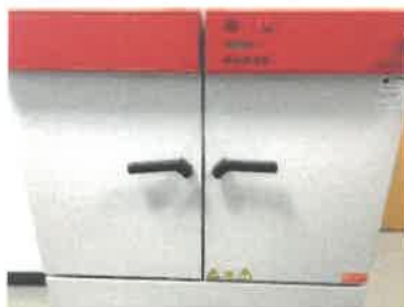
Incinte termostatare pentru incubare culturi bacteriene
