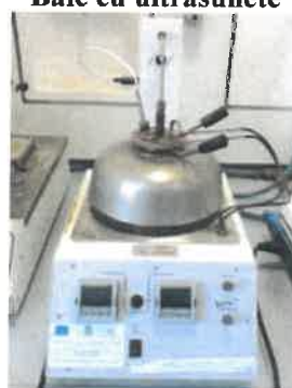
Tester inflamabilitate cu cupa inchisa
