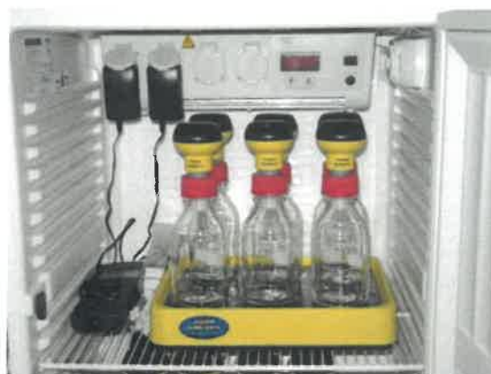
Instalație pentru teste respirometrice (rata de respirație a namolului activ în prezența toxicului)
