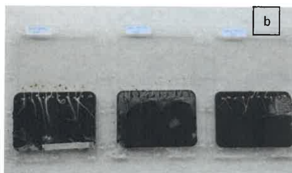
Microplaci pentru testarea toxicitatii cu plante: a) de apa; b) superioare
