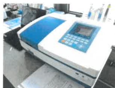
Echipamente microbiotest pentru testarea toxicitatii cu alge verzi
