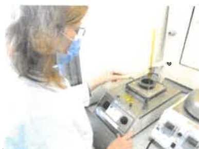
Tester inflamabilitate cu cupa deschisa
