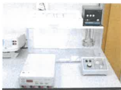
Sistem de electroforeza DGGE
