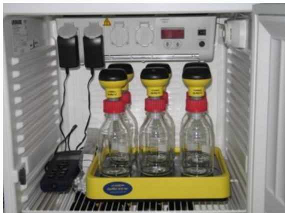
Instalatie pentru teste respirometrice (rata de respiratie a namolului activ in prezenta toxicului)
