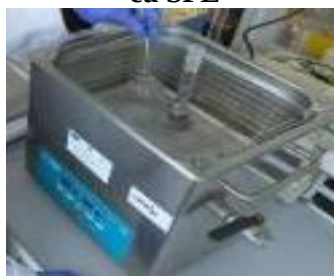
Baie cu ultrasunete
