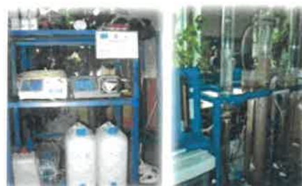
Instalație model de epurare biologică cu biomasă fixată
