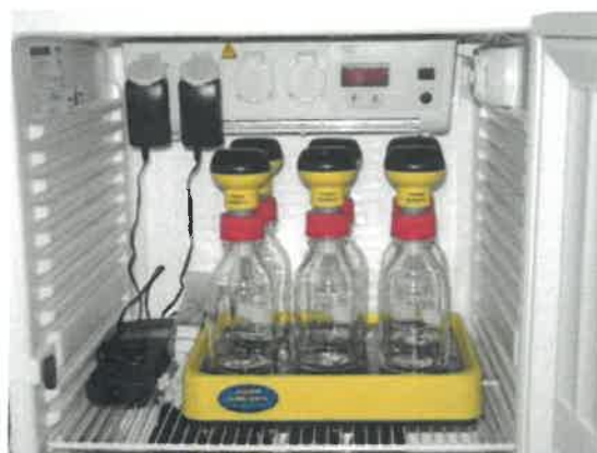
Instalație pentru teste respirometrice (rata de respirație a namolului activ în prezența toxicului)
