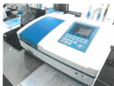
Echipamente microbiotest pentru testarea toxicității cu alge verzi
