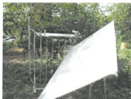
Instalație solară de fotooxidare
