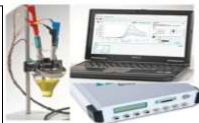
Fig. 11. Configurația sistemului portabil de detecție electrochimică a PFAS, incluzând potențostatul \mu Stat 4000 și senzorul BDD-MIP.
